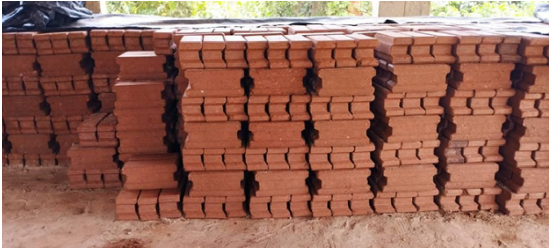
Ladrillos de tierra compactada y estabilizada.
